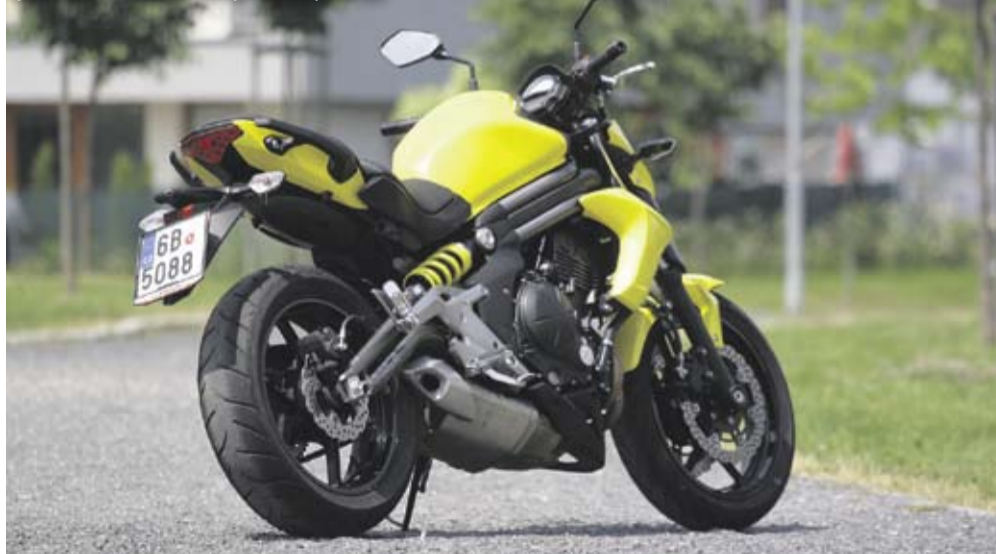
Po pravé straně uložený tlumič a výfuk pod motorem jsou stále nezaměnitelnými znaky ER-6n
